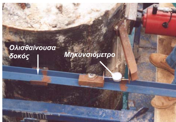
Φωτ. 2. Διάταξη μέτρησης μεταβολής οριζόντιας απόστασης μεταξύ πασσάλων Photo 2. Lateral pile displacement measurement layout.
